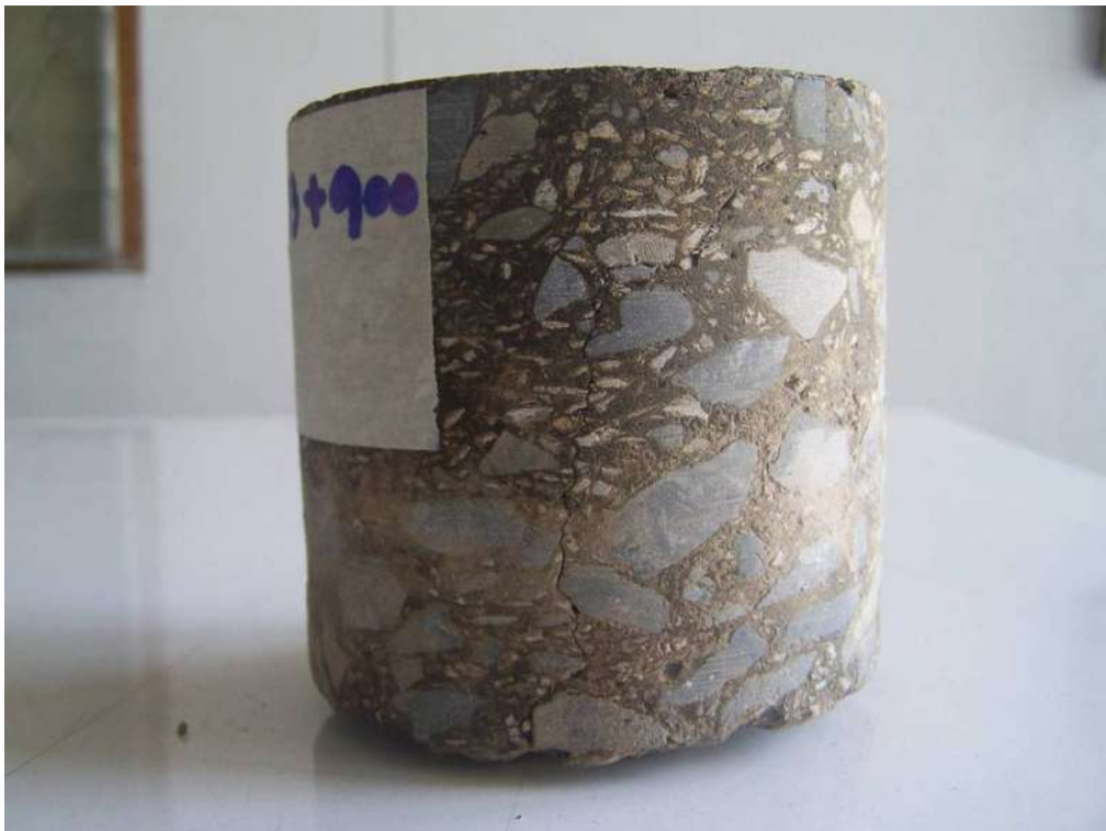
รูปที่ 4.12 ก้อนตัวอย่างเพียง 1 ก้อนที่อาจเสียหายจากรอยแตกจากล่างขึ้นบน
