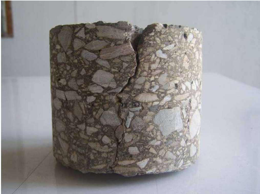
รูปที่ 4.11 ก้อนตัวอย่างที่เสียหายจากรอยแตกจากบนลงล่าง
