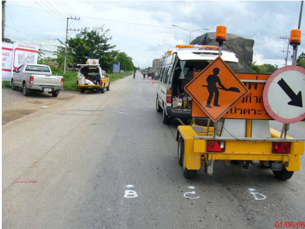
รูปที่ 3.5 การทดสอบความแข็งแรงโครงสร้างถนนด้วยเครื่อง FWD
